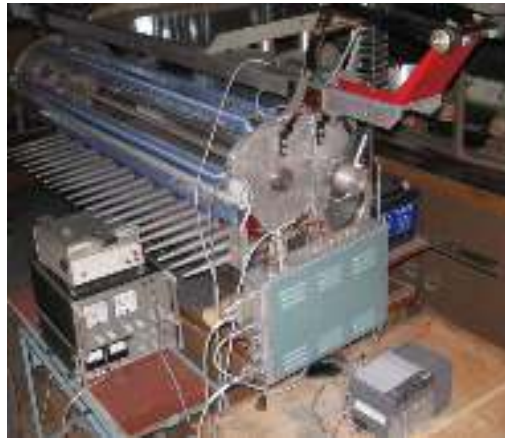
საკრეფი სისტემა გამოსაცდელ სტენდზე
